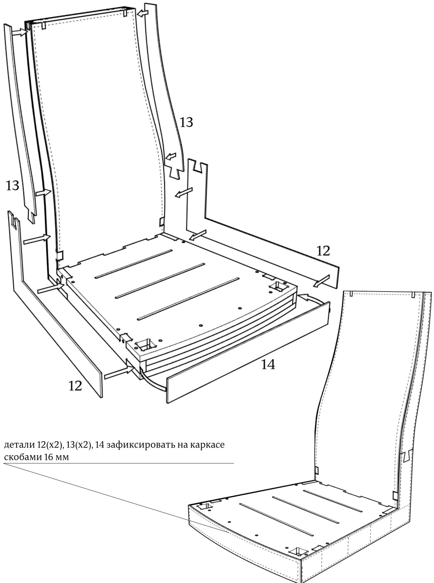
детали 12(x2), 13(x2), 14 зафиксировать на каркасе скобами 16 мм
