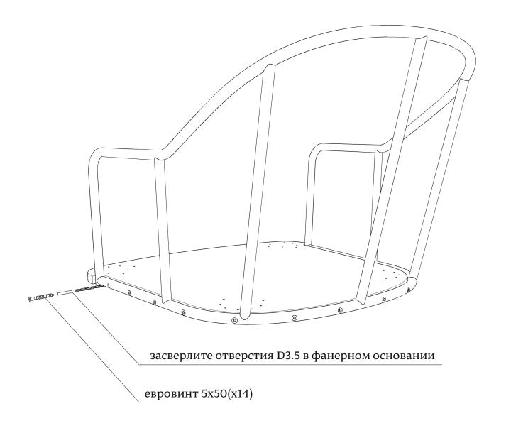
При засверливании деталей обращайте внимание на направление оси сверления- держитесь в габаритах детали!
