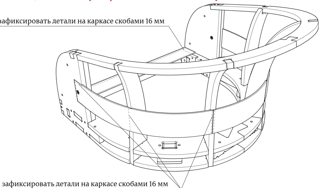
закрепить детали на каркасе скобами 16 мм
